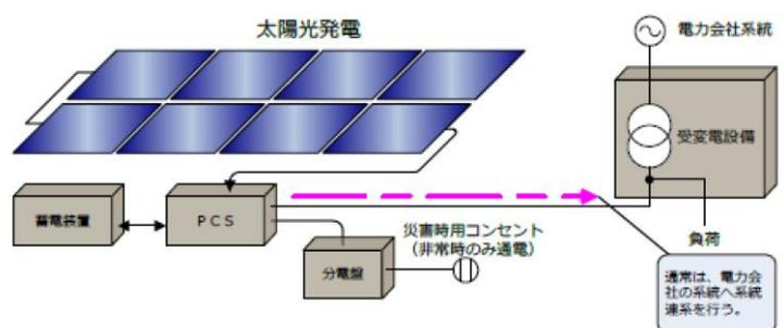
災害時対応可能な太陽光発電設備構成のイメージ
